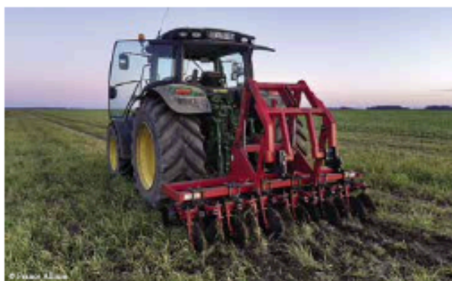
Passage du strip-till 6 rangs dans le couvert vivant avec des disques butteurs pour dégager des lignes de semis de 10 cm.
